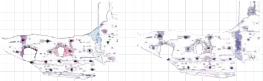
Südwand der Vorburg. Befundung und Schadenskartierung. Rot markiert die Schadensbilder, schwarz die Baubefunde.
